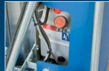
6 1,5 kw starkes Antriebsaggregat
