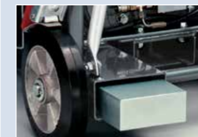
Ballastgewichte für den Einsatz kürzerer Ausleger
