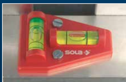
4 Libellenwaage für eine standsichere Aufstellung
